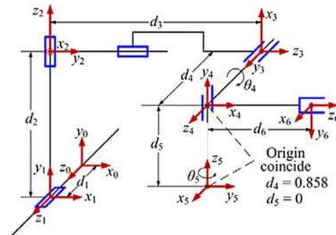
Table II DH parameters of the FSW robot
