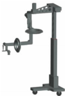
图 1 7-DOF 上肢康复机器人的 Pro/e 结构模型图
