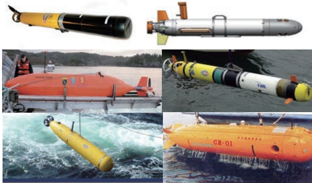
图1 不同舱部外形水下机器人 Fig.1 Different head shapes of AUV
