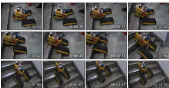
图 10 机器人自主攀爬一侧有墙的楼梯
