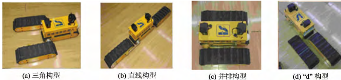
图1 可变形机器人 AMOEBA-I 常用构型
