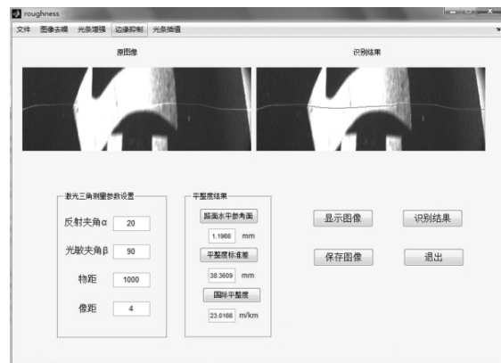
图 5 激光线识别及平整度计算 GUI 界面
