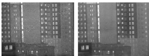
(e) 校正前场景 3 偏振度图像 (f) 校正后场景 3 偏振度图像 (e) Polarization image of scene 3 before NUC (f) Polarization image of scene 3 after NUC
