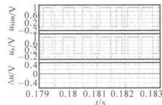
图 3 PWM 输出等效性验证波形
