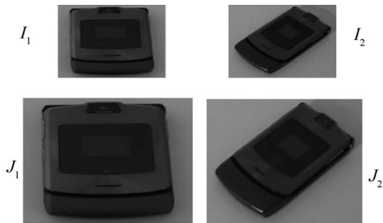
图2 I_1 和 I_2 分别是手机图像 I 经 f 和 g 变换而得; J_1 和 J_2 分别是图像 I_1 和 I_2 经 h 变换而得(不变性条件意味着图像 I_1 和 I_2 的距离应当与 J_1 和 J_2 的距离相同)
