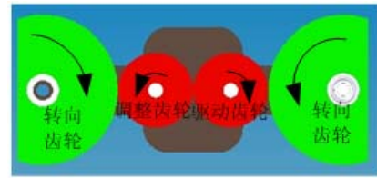
图5 变形虫 II 变形主体驱动原理
