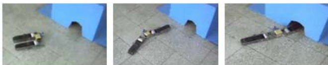
图 13 机器人展开后钻洞实验
